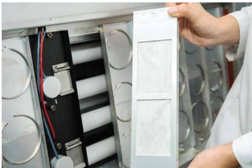
可降解口罩和髮網通過「紫外線加速老化試驗箱」測試，於六星期完成降解程序。
