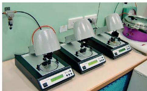
▲ 氣壓機——用作測試表芯在壓力下的防水功能。
