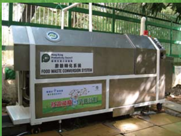
（圖左）適用於家居、學校等小型廚餘轉化系統約1米高，消化反應器的體積較小；（圖右）而大型廚餘轉化系統可供商場和食物加工廠使用
