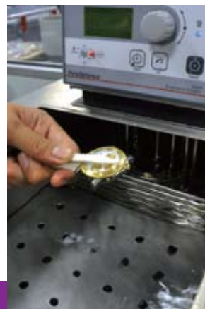
熱衝擊防水能力測試裝置
