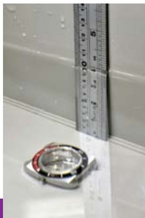
淺水防水能力測試裝置
