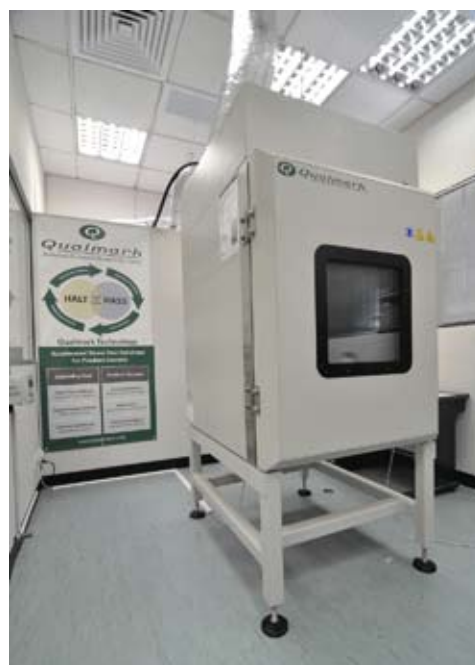
作為Qualmark的香港區首家指定測試實驗室，可靠性測試中心可提供快捷的高加速壽命測試服務
