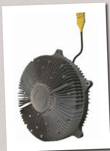
BorgWarner 的 Viscronic 風扇驅動裝置，適用於福萊納卡斯凱迪亞（Freightliner Cascadia）8級商用車的 DD13 和 DD15 發動機
