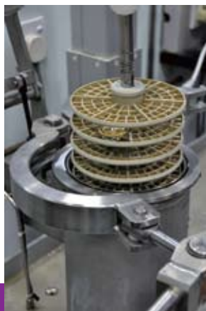
過壓防水能力測試裝置
