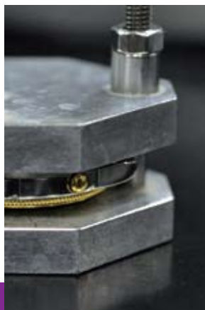
操作部件承受拉力之下的防水能力測試裝置
