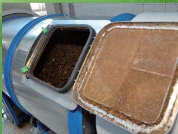
廚餘在消化反應器中轉動，以細菌分解成為有機肥料
