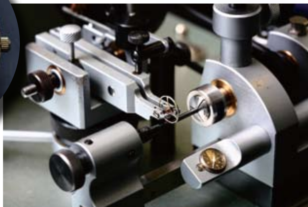
平衡擺輪測量裝置，測試工件是否處於平衡狀態
