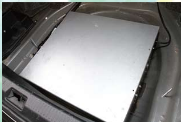
新空調系統需在車頭及車廂進行改裝工作，加入馬達皮帶驅動壓縮機、電池及控制設備
