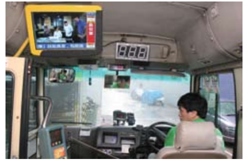
車上裝設乘客顯示屏、主控硬件和換線提示盒/司機拍卡記錄
