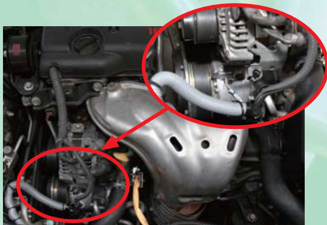
新空調系統需在車頭及車廂進行改裝工作，加入馬達皮帶驅動壓縮機、電池及控制設備
