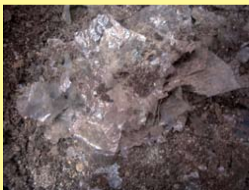
圖二：可降解塑袋埋在泥土下數月後開始降解
