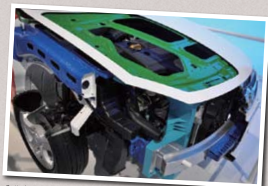
全塑料前端模塊整合了散熱器、前照燈、鎖橋及緩衝樑等，讓汽車的前端結構大為精簡
