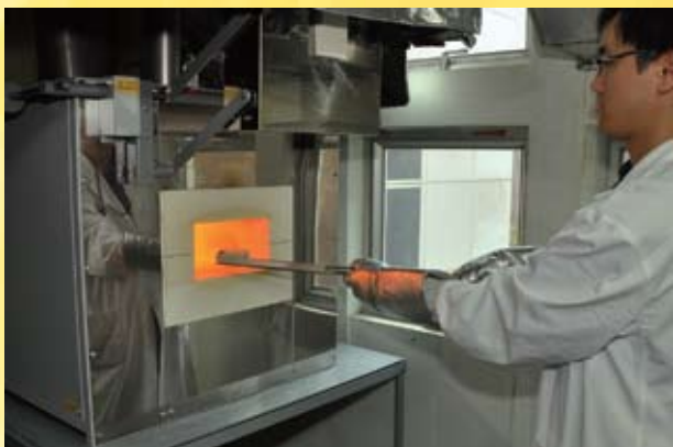
在黃金成色的測試程序中，以高溫熔爐燃燒樣品的步驟最為關鍵
