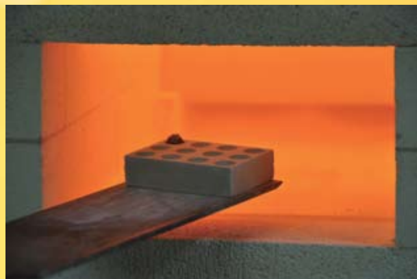
在黃金成色的測試程序中，以高溫熔爐燃燒樣品的步驟最為關鍵
