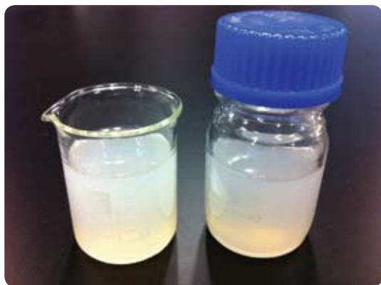
「溶膠-凝膠」是同時包含液相和固相的膠狀懸浮液，類似美容用的膏狀面膜
