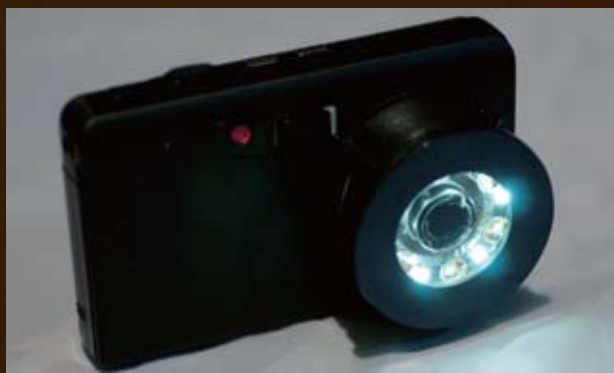
便攜式人體皮膚圖像捕捉設備的功能性原型，外型類似全自動數碼相機，方便醫生隨身攜帶。
