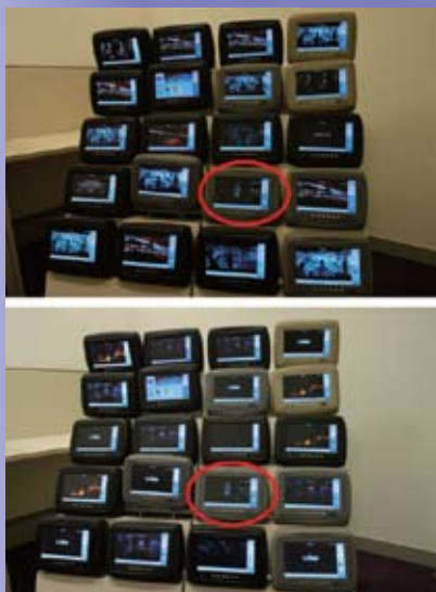
圖中紅圈為使用「略過模式」的顯示器終端，節目停止播放，其他的顯示器終端並不受到影響
