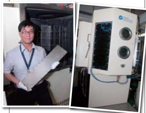
莊一鳴博士介紹，生產力局自設鍍膜設備，製成可抗菌的納米複合塗層
