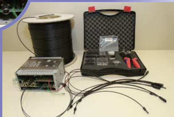
塑膠光纖連接主控制器和各個顯示器終端；小圖為主控制器，內設置印刷電路板、MPEG板和DTV天線
