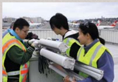
科大與HP合作研發了遠程大容量「無線『多跳』網狀網絡」，可增強Wi-Fi的覆蓋。
