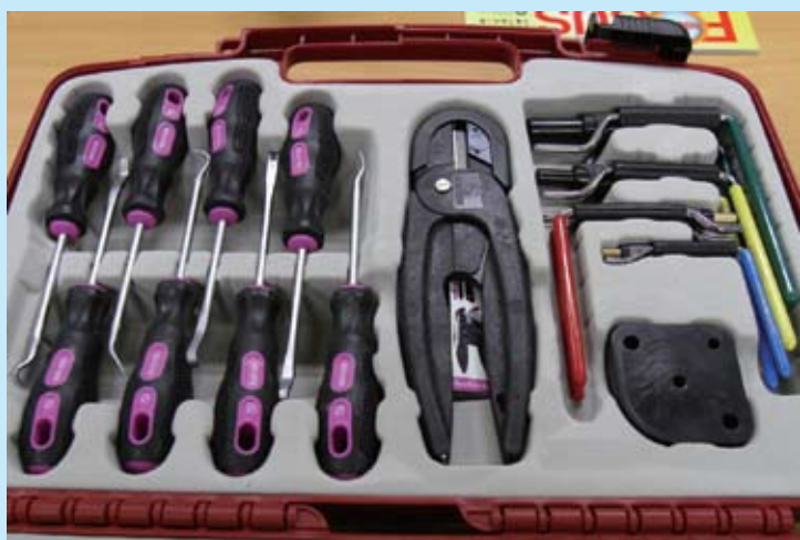
為減少因設計、形狀、安裝和使用不當而發生的故障，業界開發了一系列安裝、拆卸、測量的專用工具，向機械行業提供實用的完整密封方案。
