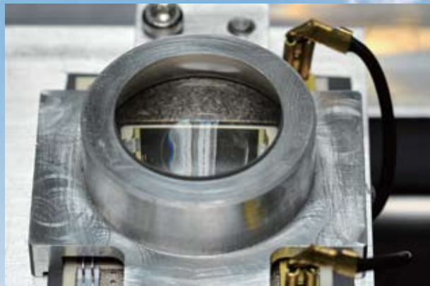
聚光型太陽能發電系統原型採用一塊透鏡作為聚焦器，把太陽光聚焦在光伏電池上。
