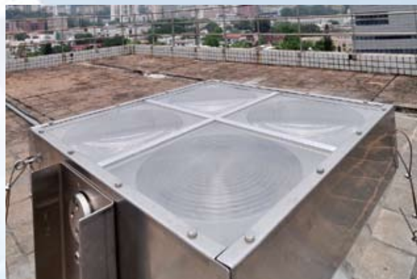
聚光型太陽能發電系統原型正在進行概念驗證及收集運作數據，以探討系統的優化空間。
