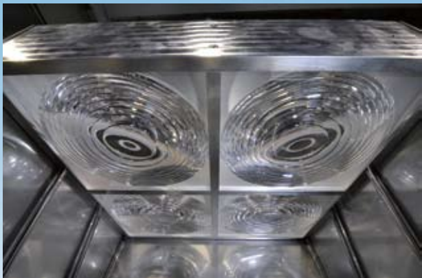
聚光型太陽能發電系統原型採用兩片菲涅爾透鏡作為收集器，可收集500倍太陽能。
