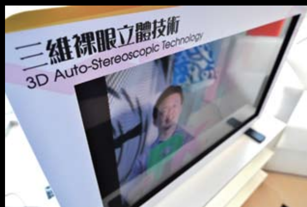
在LCD電視表面上加上一層網狀的光學薄膜，根據鏡片和LCD顯示器，利用數碼圖像方法，處理左、右眼的視差影像，即可「裸眼」觀看最理想的3D影像。
