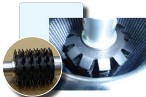
磁力濾芯可大量捕捉小於 1\mu\text{m} 的鐵金屬污染物結合 10\mu\text{m} 玻璃纖維濾芯使用，適合處理要求NAS 8級或ISO code 19/17/14的液壓系統回路。
