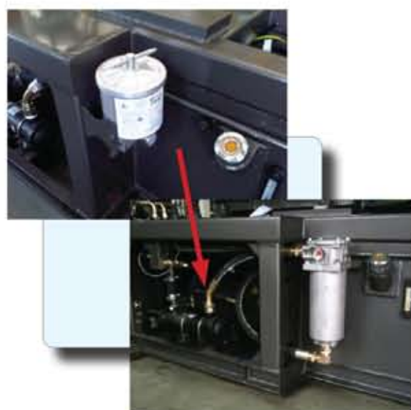
液動力控制有限公司作為華大機械有限公司的策略性合作伙伴，開發針對其伺服電機泵節能系統的磁力與玻璃纖維濾芯組合式過濾器，可提供全流量過濾，有效確保液壓系統清潔度要求。
