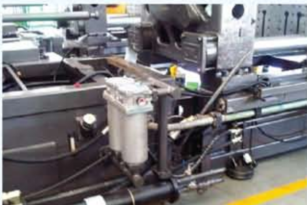
在液壓式注塑機當中，開鎖模、儲料、保壓、頂出、調模等關鍵的動作，也由液壓系統提供動力。
