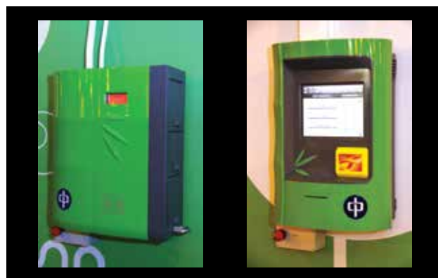
（圖左）EV-MegaNet充電點裝設了關鍵技術，與電動車的車載充電系統溝通；（圖右）終端機處理多個充電點的數據傳輸，以及付款確認工作。
