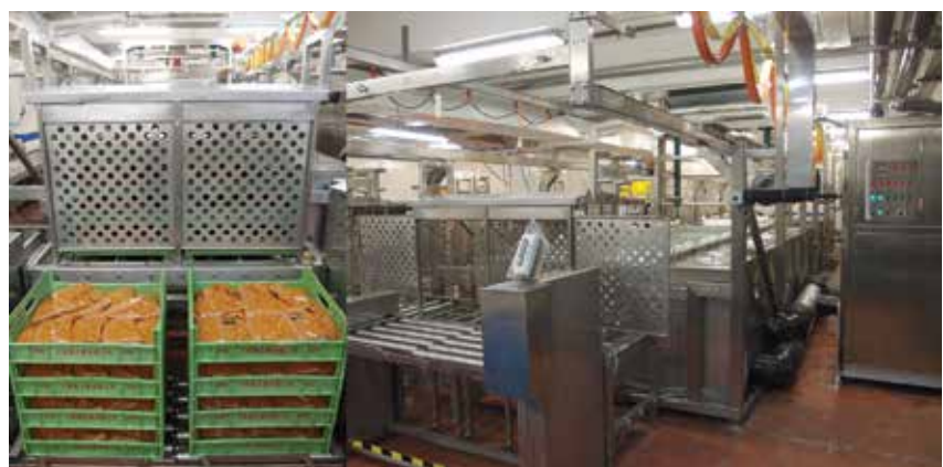
生產力促進局開發了專為食品加工業而設的「自動化液態冷凍系統」，多功能設計適用於各種冷凍包裝食品，有助業界節省運作成本和水資源。
