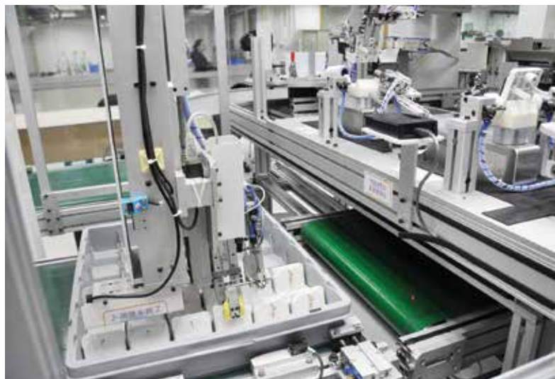
由生產力促進局設計的自動產品編號和包裝生產系統結合自動打槍、編碼及包裝等工作，提升「收貨」工序的準確性。
