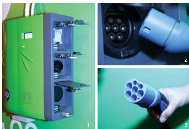
1. EV-MegaNet兼容多個國際標準的充電制式。 2、3. 充電點的底部為歐洲IEC的三相充電插座，具有更大功率輸出量。
