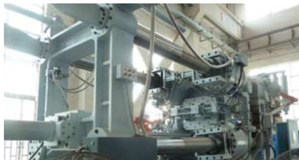
系統採用獨立哥林柱結構，改善品質控制。
