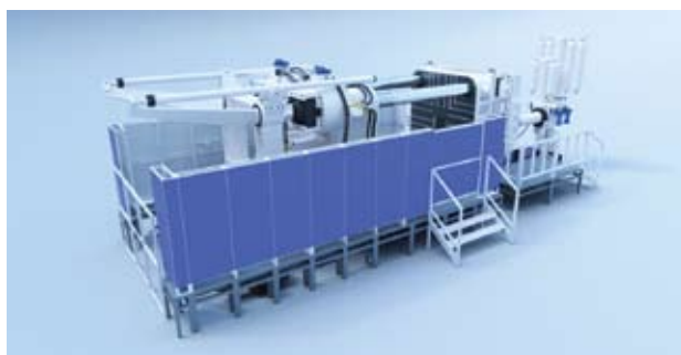
生產力局與本地機械廠合作開發了大型兩板冷室壓鑄機，顯著提升大型壓鑄件的強度和品質。
