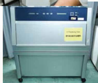
「紫外線加速老化試驗箱」進行可降解測試。
