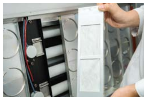
「紫外線加速老化試驗箱」進行可降解測試。
