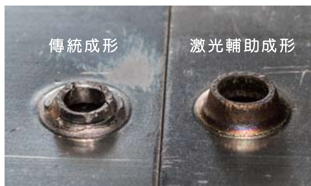
圖右為使用激光輔助漸進成形技術製造的部件，與圖左的傳統方法相比，可見利用激光可提升材料成形能力，解決裂紋問題。
