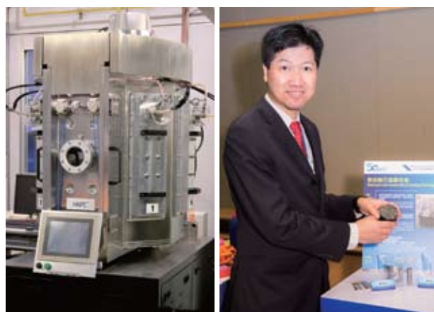
生產力局研發出類金剛石碳納米塗層的示範設備。盧偉賢博士表示，使用直流 - 交流電源疊加偏置技術可加強熱應力控制，提升塗層的附著力和硬度。
