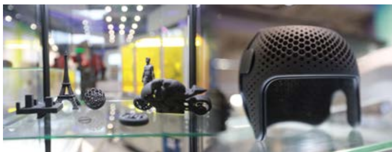
射流熔融3D打印技術可大幅提升工件的機械強度
