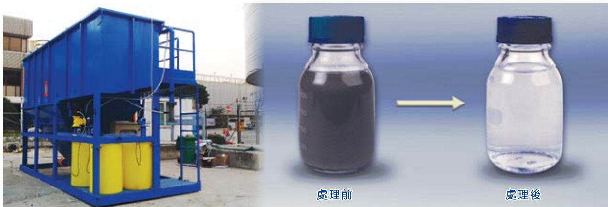
生產力局開發的建築地盤污水處理系統，適合各大小工地應用，達到排放標準，並已在香港、中國內地、新加坡及馬來西亞註冊專利。
