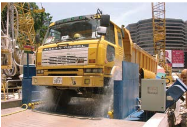
自動化輪胎清洗機可為離開建築地盤的車輛，自動沖洗輪胎表面的泥土或砂石，已在香港及中國內地註冊專利。
