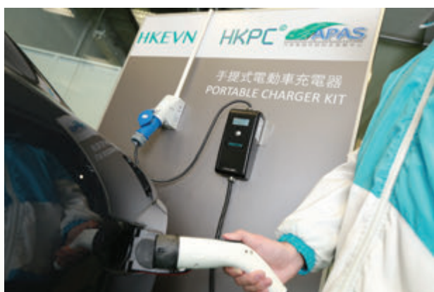
「手提式電動車充電器」的獨立充電器及插座，可以大幅減低停車場安裝充電樁的成本。
