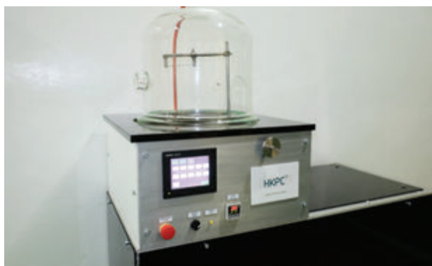
製造防污表面塗層的鍍膜過程，完全在真空的機艙內進行，工序安全環保，處理一張A4紙的成本約0.2至0.5港元。
