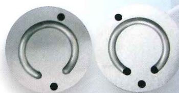
Tooling Surfaces Before Diffusion Bonding 焊接前的截面
