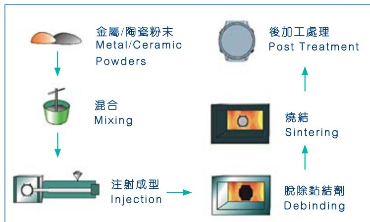
展潛力相當可觀。林浩生表示，粉末注射成型技術(PIM)是一種結合粉末冶金和注射成型的技術，可應用於金屬注射成型(MIM)及陶瓷注射成型(CIM)，並具有精度高、性能優異及生產成本低等優點，由於它能生產接近最終成型之零件，減少後加工處理，可為業界提供快捷及更多創新元素的產品。
