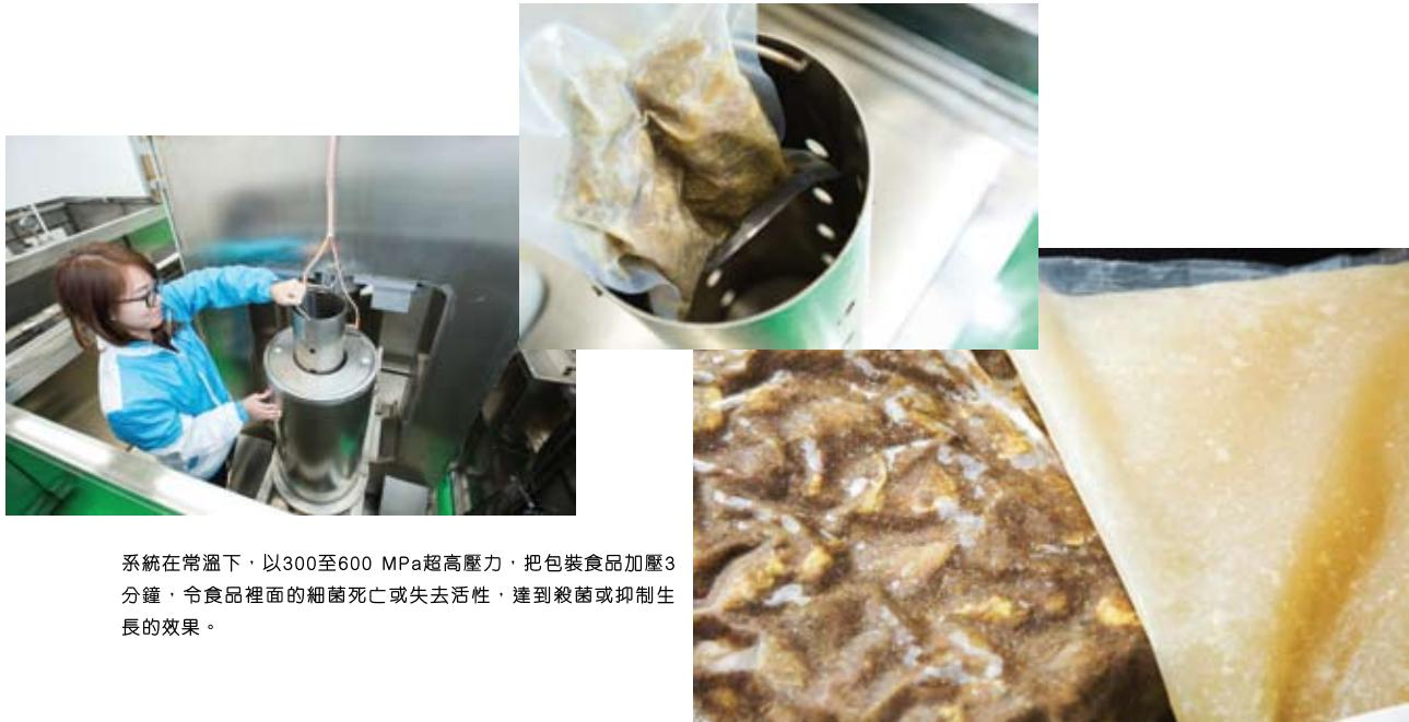
系統在常溫下，以300至600 MPa超高壓力，把包裝食品加壓3分鐘，令食品裡面的細菌死亡或失去活性，達到殺菌或抑制生長的效果。
