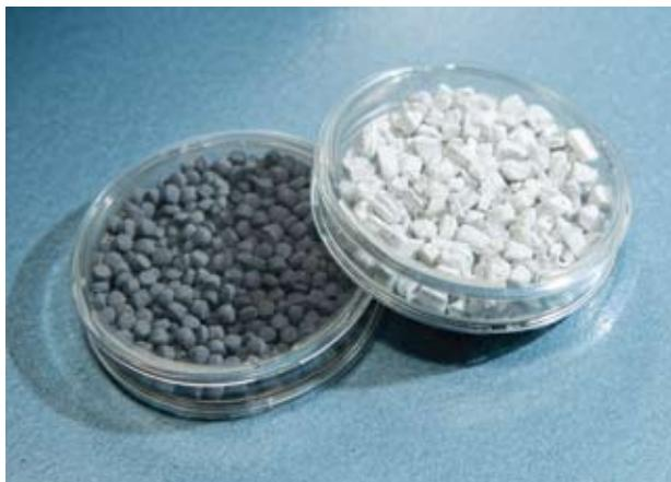
生產力局成功研發微粉末注射成型的先進喂料配方。
