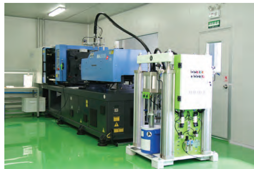
剛輝與生產力局合力設立 10 萬級無塵車間，開發了由標準注塑機改裝而成的高精密 LSR 注塑生產系統
