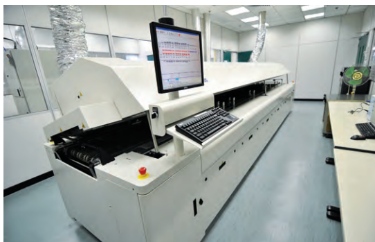
可靠性測試中心添置了全長6.3米的回流焊模擬熱應力測試設備，可為多層電路板進行精確的模擬溫度應力測試，協助發展高質素的多層電路板
