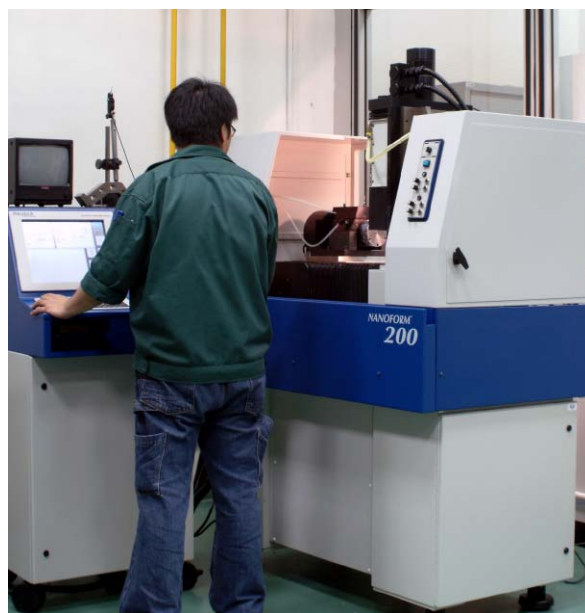
生產力促進局透過引進多種微製造技術及機械，為本地關鍵性零部件行業，包括光學、醫療產品及電訊行業提供微製造超精密加工技術的顧問服務。圖示四軸自由曲面機床。
