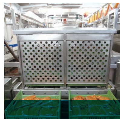
液體速凍系統可在20分鐘內把熱包裝食物由85°C降溫至20°C。
