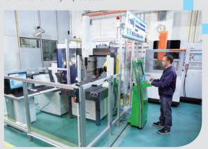
為協助香港廠商引入更靈活的製造管理模式, 生產力局在「創新及科技基金」的資助下, 成立「i-mfg 智能製造技術展示中心」,以模具業為試點, 向業界示範智能自動化模具生產線的實際運作。 i-mfg 引入德國智能模具製造系統,連接所有生產設備, 將工程設計、產品製造與企業管理集於一身, 廠商可於短時間內生產不同規格的零件。
