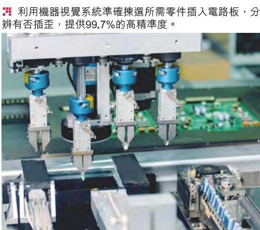
■ 利用機器視覺系統準確揀選所需零件插入電路板，分辨有否插歪，提供99.7%的高精準度。
