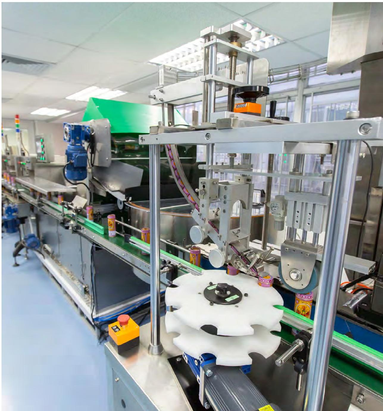
■ 研發於2020年7月完成，現時可一站式處理油樽外包裹說明書、入罐、封罐蓋、檢查多個工序及外觀要求等，每小時可包裝3,000樽藥油。
