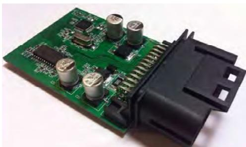
■ 電噴系統中，控制芯片無疑是核心，第二代電噴系統已開始採用先進的控制算法，排放效能優於原來的排放標準70%。
