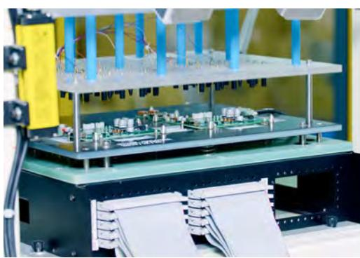
■ 機械臂放置電路板後會自動進行測試及分類，同時會收集數據測試結果並自動存檔，可隨時查看造成次品原因，長遠可利用大數據分析，提升品質。
