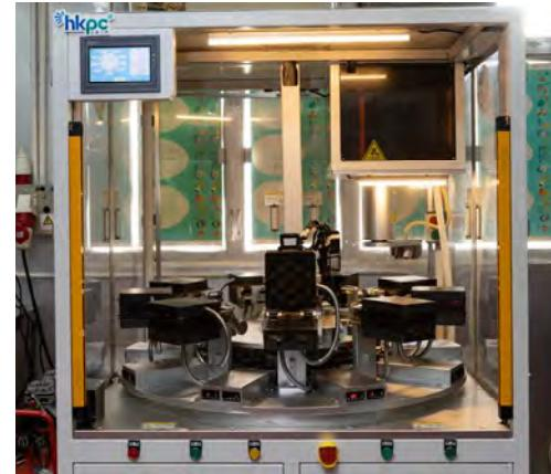
機器一小時可以製作54底，並只有1.2米長及闊，以及1.7米高，底部亦有4個輪，可隨意「走位」。
