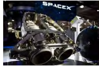
SPACEX 龙飞船 2 号的核心部件 SuperDraco发动机
