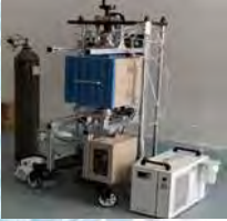
OTF-1200X-VHP4 開敞式立式爐，標配 dia4" 石英管真空密封，20T 電動壓力機，是在真空高壓下製備緻密化合物材料的理想工具，在 5 噸壓力下可融合多層薄片，爐子可以加熱到 1100 °C，並且 30 段程式控溫，帶水冷的法蘭可使真空度達到 10 -5 Torr (用分子泵)
