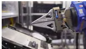
金属3D打印机制作的17-4 PH不锈钢抓手
