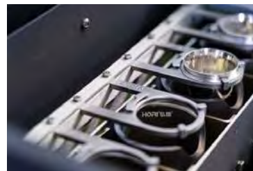
3D打印的镍铬铁合金625(Inconel 625)坩埚夹
