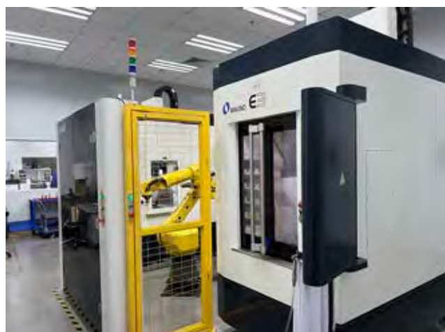
力嘉 - 石墨電極加工自動化
