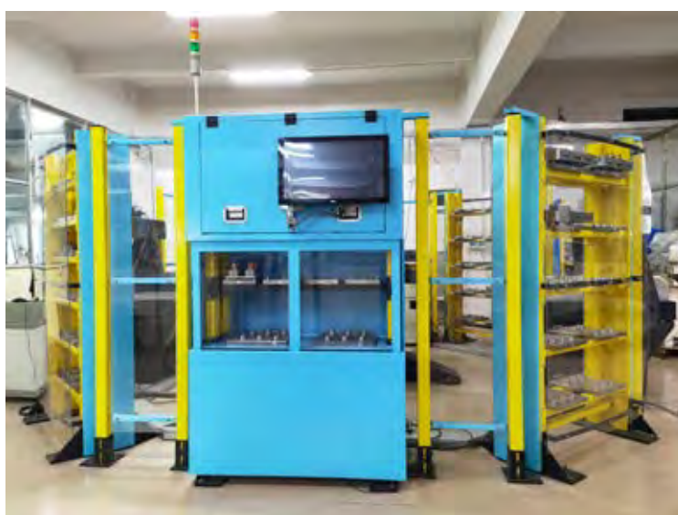
信興 - 電極三坐標測量自動化
