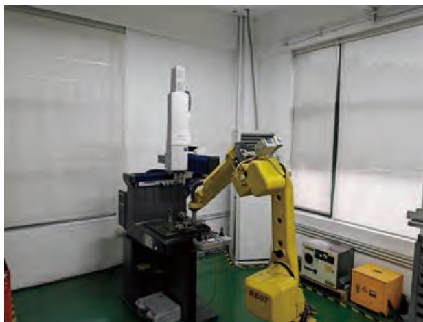
東江 - 銅工電極自動化測量
