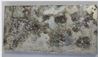
圖 3-2 四種材料經歷不同腐蝕時間後的表面形貌照片
