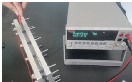
陰極集流體與右上角固定螺栓電阻
