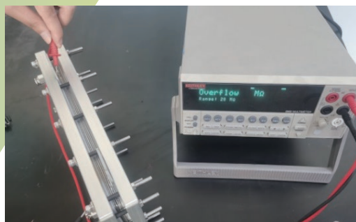
陰極集流體與左上角固定螺栓電阻
